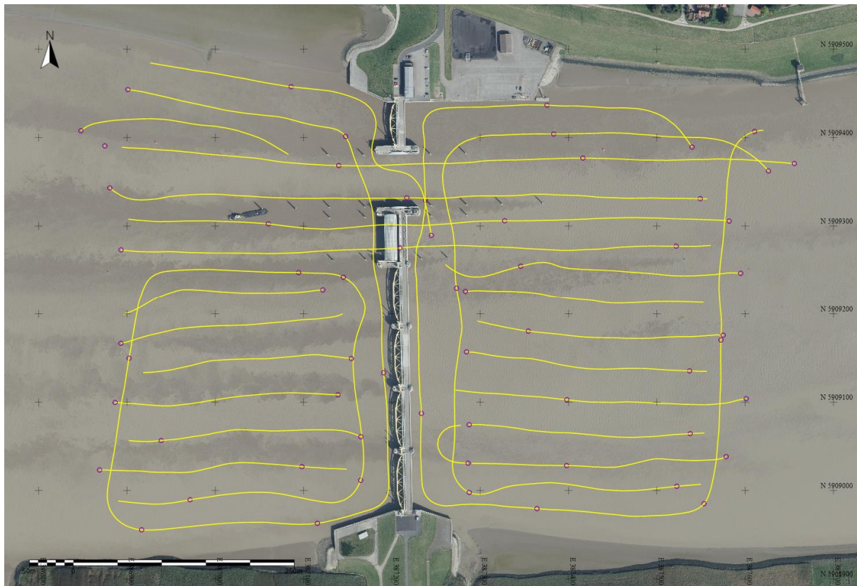
Abbildung 29: Streckenführung der Peilfahrten am Emssperrwerk
