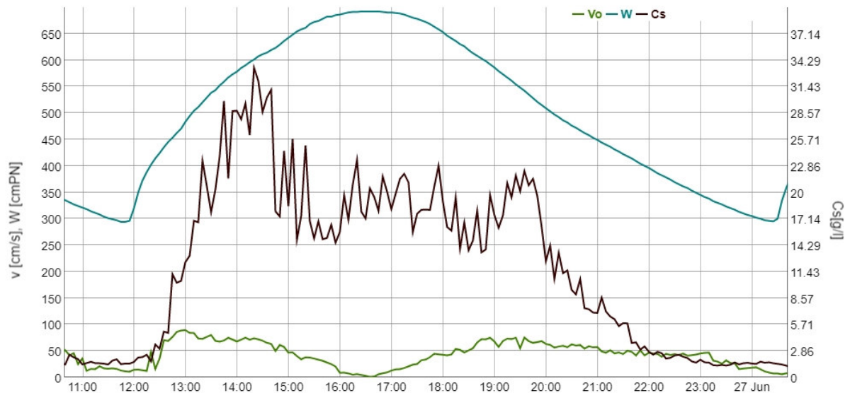
Abbildung 81: Hochaufgelöste (5 min - Werte) Ganglinie des Wasserstandes am Pegel Papenburg, Strömungsgeschwindigkeit am mobilen WSV Messstrang Papenburg sowie Schwebstoffkonzentration an der Gewässergütemessstelle des NLWKN
