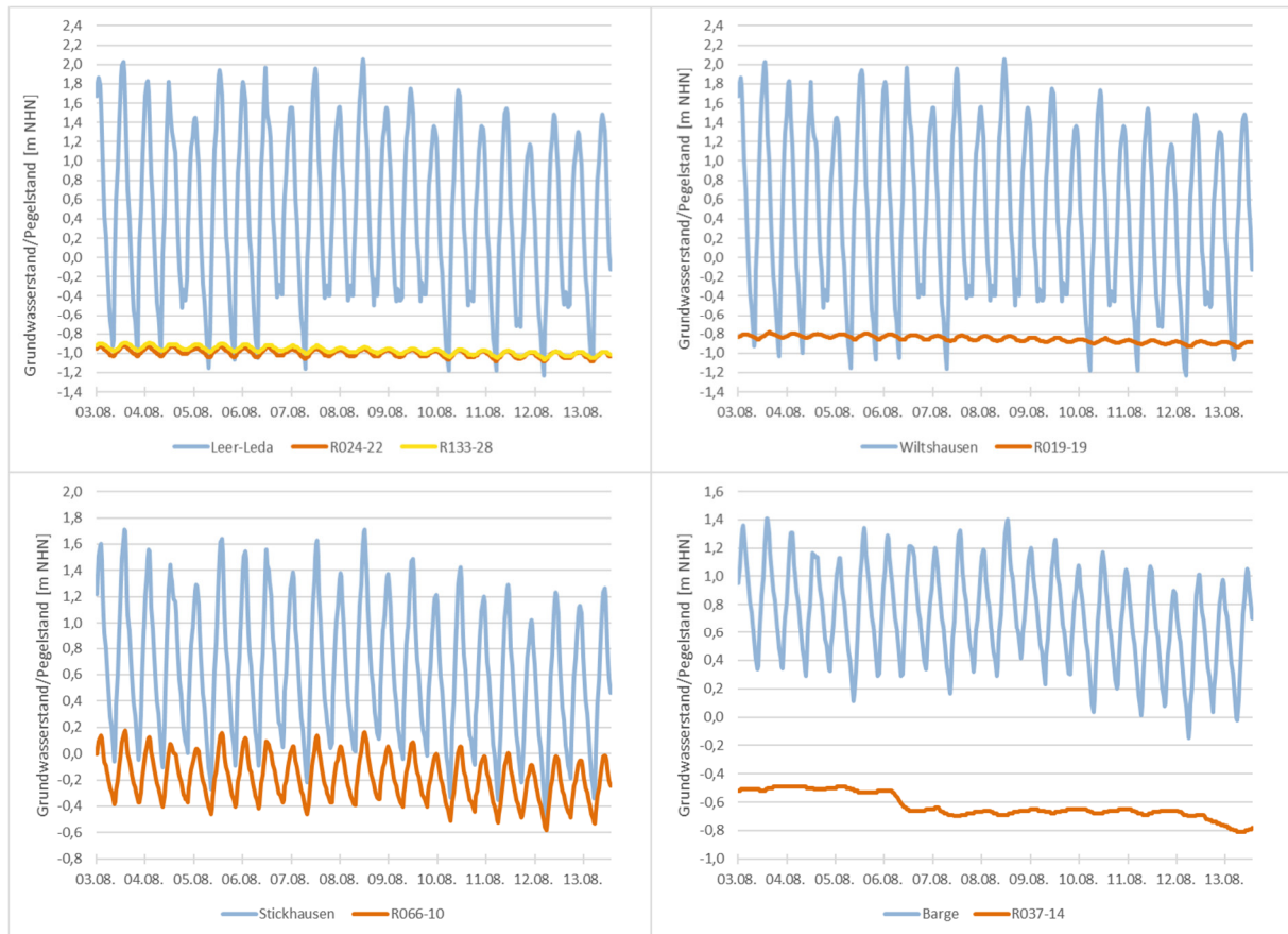
Abbildung 62: Vergleich der Grundwasserstandsganglinien der Messstellen R024-22 und R133-28 mit den Messwerten des Oberflächengewässerpegels Leer-Leda, der Grundwasserstandsganglinien der Messstelle R019-19 mit den Messwerten des Oberflächengewässerpegels Wiltshausen, der Grundwasserstandsganglinien der Messstelle R066-10 mit den Messwerten des Oberflächengewässerpegels Stickhausen sowie der Grundwasserstandsganglinien der Messstelle R037-14 mit den Messwerten des Oberflächengewässerpegels Barge anhand von 30-Minutenwerten für den Zeitraum vom 03.08. bis 13.08.2020.
