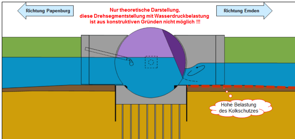
Abbildung 7-14: Strömungsbelastung Kolkenschutz, Unterströmung des Verschlusses (Schütz)
